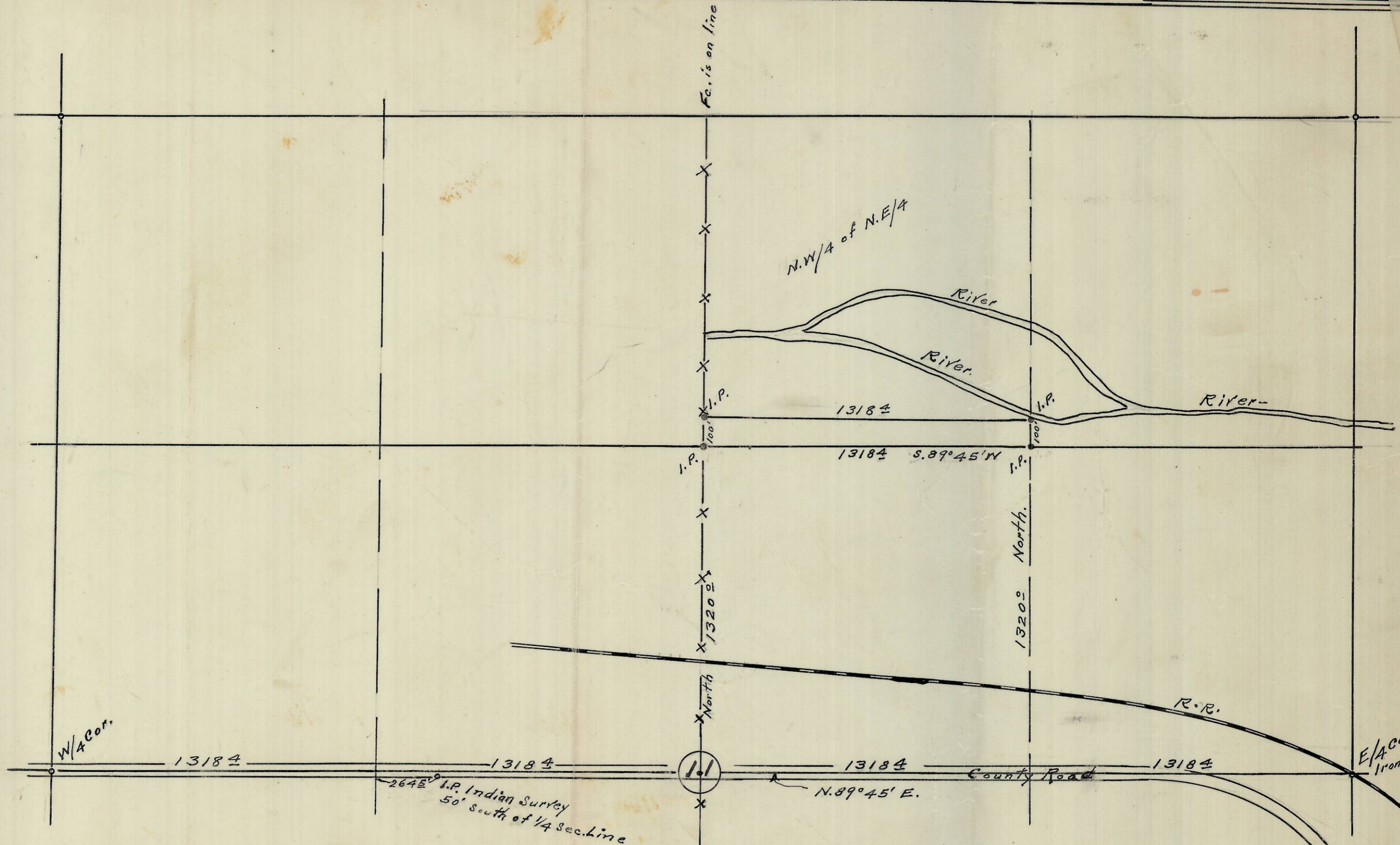
Map showing the South 100± Ft of The N.W./4 of N.E./4 - Sec. 11 - T. 2 N., R. 33 E. W. M. Surveyed, staked & plotted 1952 - By H. L. Melton - Scale: 1" = 400'
